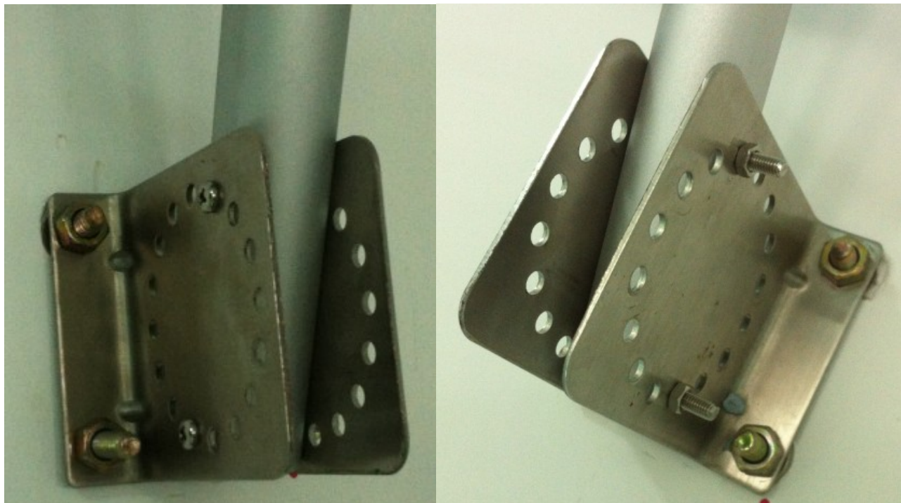
终端杆万向底座安装方式
